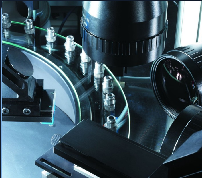
Станция оптической инспекции: камера и свет фиксируют дефекты, невидимые глазу
